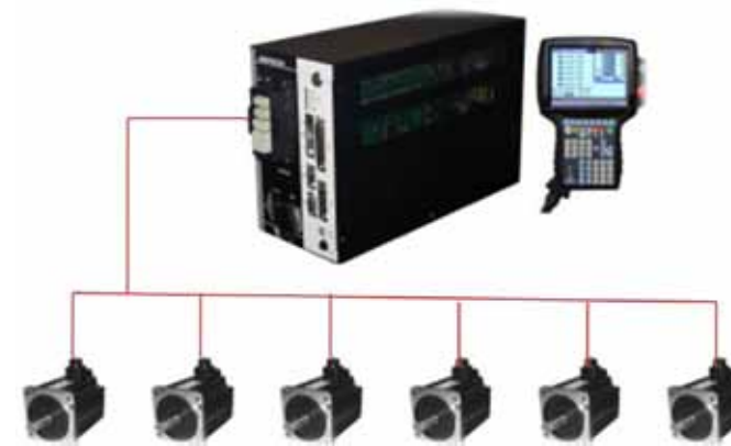
图 3：第三阶段 驱控一体化的控制方案
