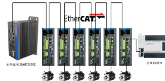
图 2：第二阶段 基于总线的控制方案
