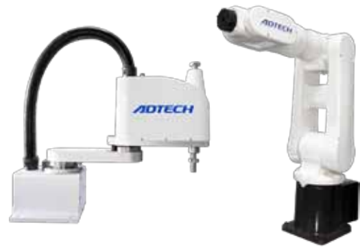
图 4：众为兴自主开发的四轴和六轴机器人
